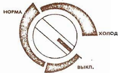
Рис. 5. Шкала температурного режима холодильников «Минск-10» и «Минск-11»: «Выкл.» — положение выключения (0), «Норма» — зона нормального холода, «Холод» — зона максимального холода
